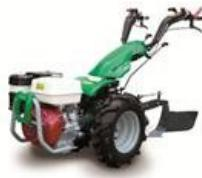
**PLUG I ZAGRTAČ:**Dizajnirani i prilagodeni motokultivatorima, omogućavajući razumno korištenje i pripremu zemljišta, za pravljenje brazdi sa sjetvu ili navodnjavanje.
