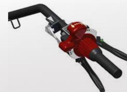
Per entrambi i comandi di avanzamento è presente un settore a tacche che consente all'operatore di fissare in modo pratico e ripetitivo la posizione della leva o della manopola. Una zona centrale priva di tacche consente libertà di posizionamento della leva o della manopola, utile per calibrare l'avanzamento della macchina a ridottissima velocità.
