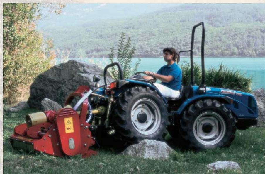
Le caratteristiche strutturali dei VALIANT sono quelle classiche dei trattori a ruote isodiametriche. Il **passo corto e il raggio di sterzata ridotto** consentono la massima manovrabilità su ogni tipo di terreno.
