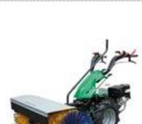
**UREDJAJ ZA ČIŠĆENJE:** sa usmeravajućom četkom sa posebnim vlaknima, koja omogućava primenu pored opšteg čišćenja i za odstranjivanje snega.
